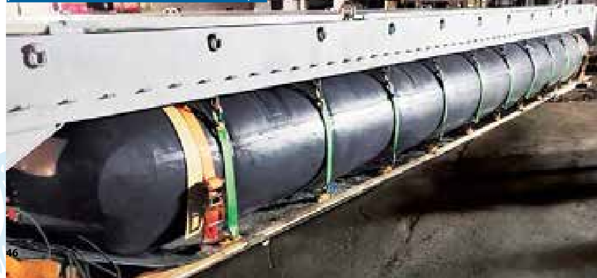
Платформа имеет размер приличного загородного дома — 10 на 12 м. На нее установлены восемь пневмобаллонов, наполненных воздухом
