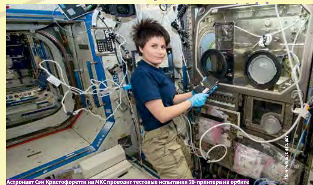
Астронавт Сэм Кристофоретти на МКС проводит тестовые испытания 3D-принтера на орбите
