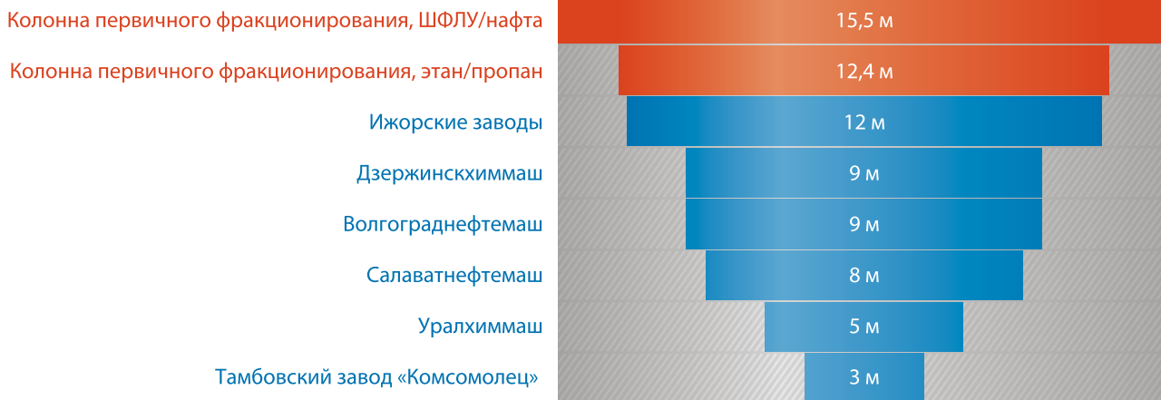
Рисунок 8. Внутренний диаметр колонн первичного фракционирования пирогаза на комплексах пиролиза большой мощности в сравнении с предельными возможностями российских заводов
