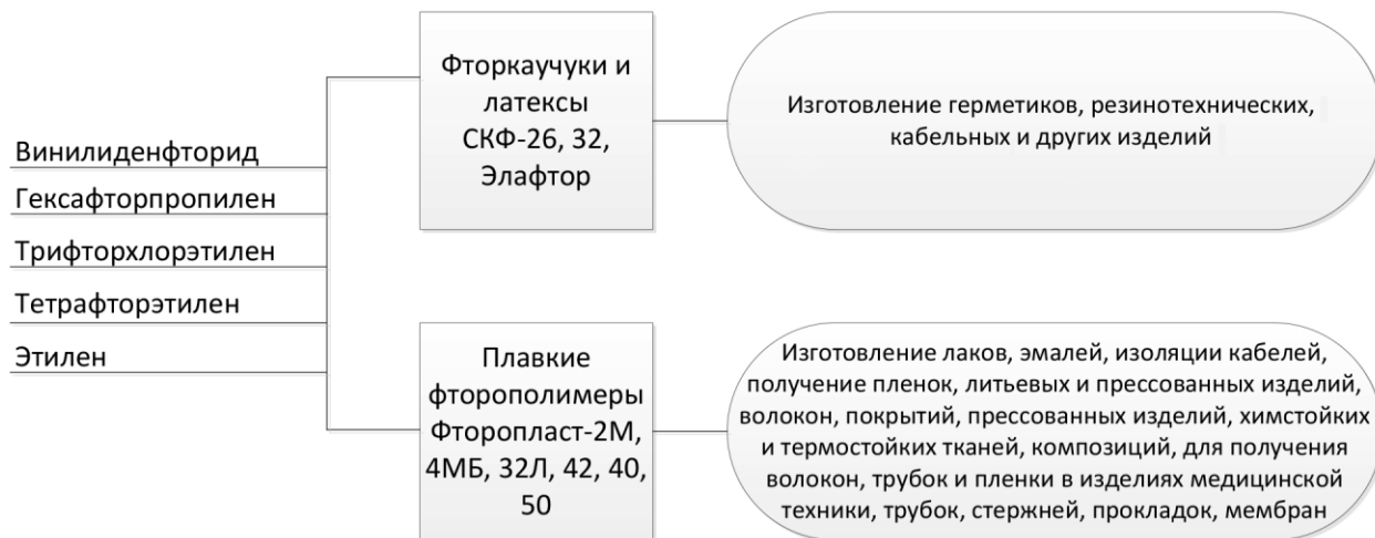
Рисунок 10.4.2 — Блок-схема распределения сырья на выпуск фторопластов
