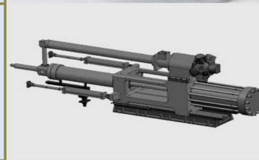
Двух-стадийный узел впрыска низкого давления
