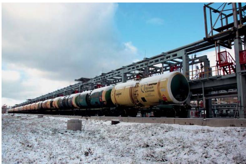
Рис. 30. Цистерны с бензином на железнодорожной эстакаде
