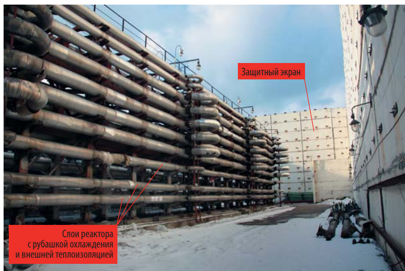
Рис. 51. Реактор полимеризации этилена высокого давления. Хорошо виден защитный экран
