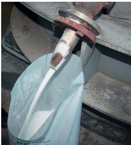
Рис. 61. Отбор пробы порошка полипропилена из аналитического бункера
