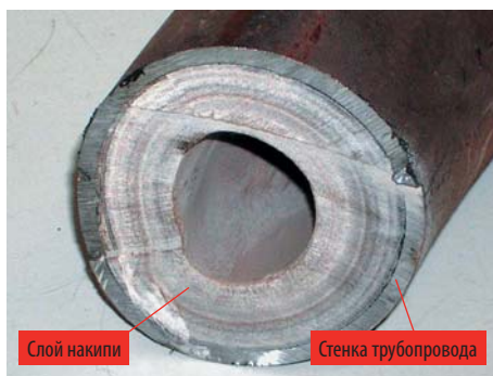
Рис. 64. Слой накипи на внутренней поверхности трубопровода. Заметно, насколько сильно уменьшилось сечение трубы
