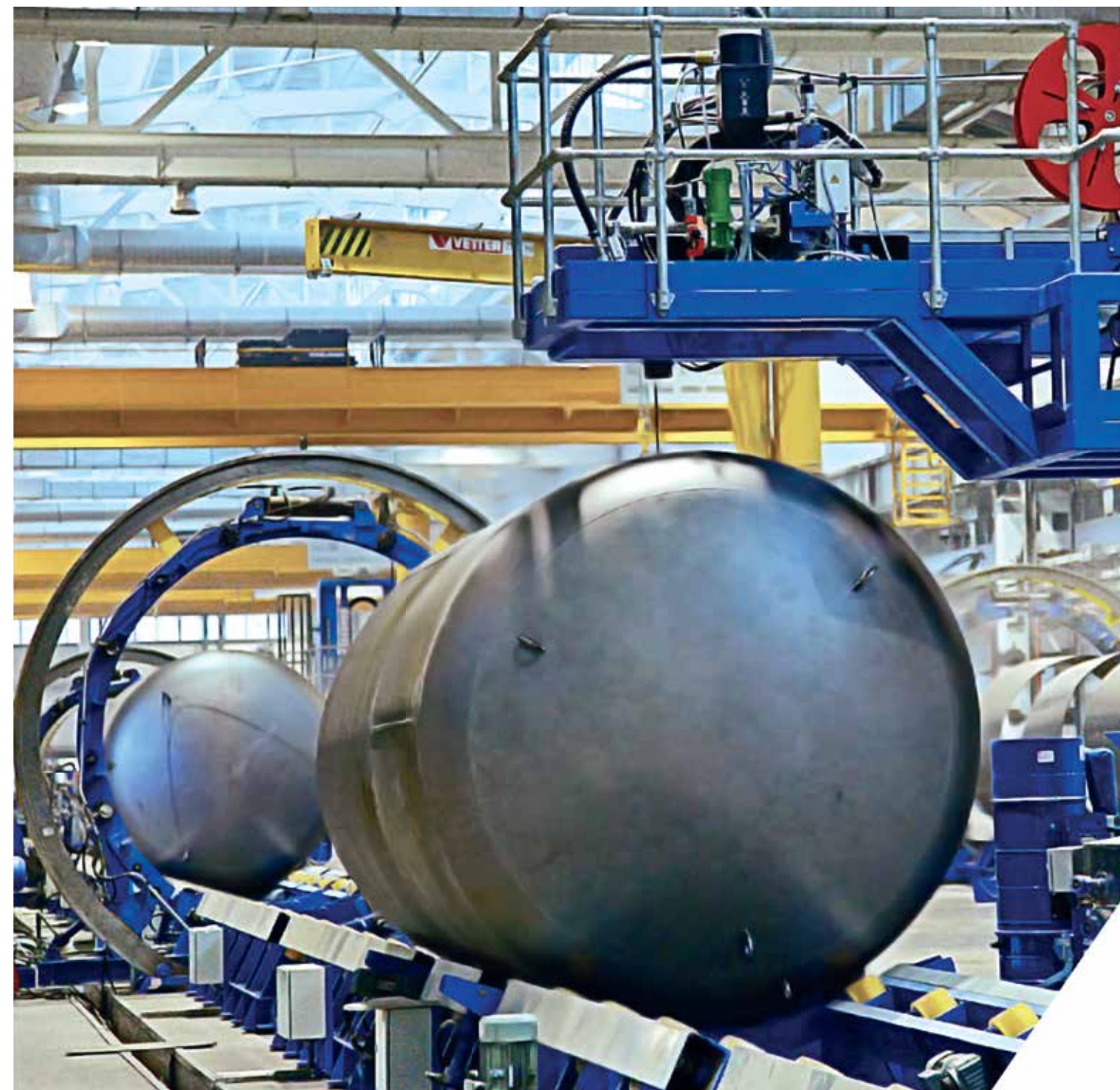
на фото: линия сборки котлов, ЗАО «ТихвинХимМаш»
