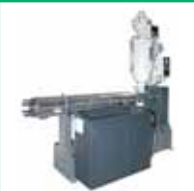
ЭКСТРУЗИЯ – придание нужной формы
