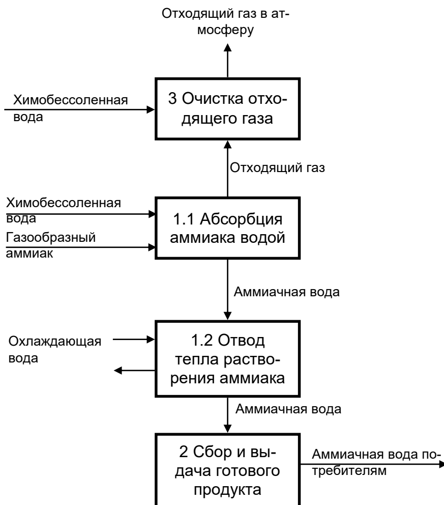
Рисунок 7.8 – Схема технологического процесса
