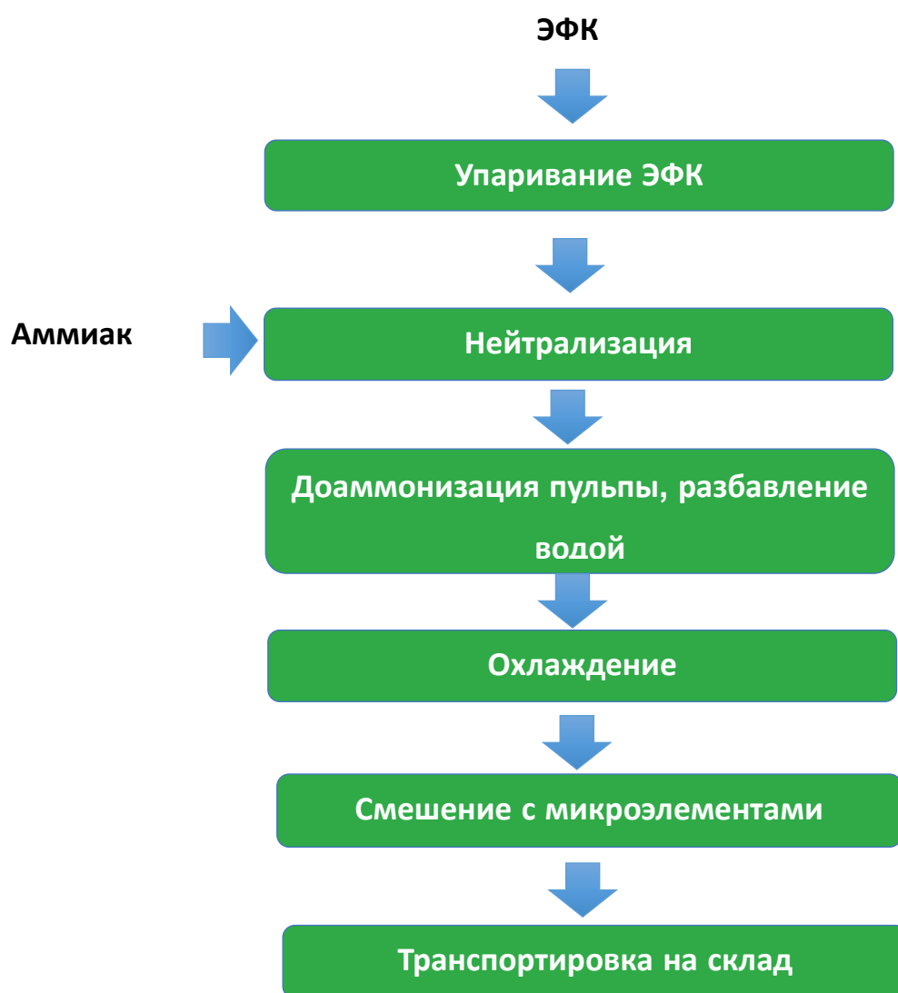
Рисунок 6.65 – Принципиальная блок схема процесса получения ЖКУ с микроэлементами
