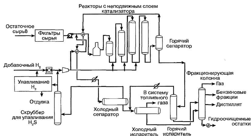
Рисунок 7.11 – Технологическая схема процесса RCD Unionfining
