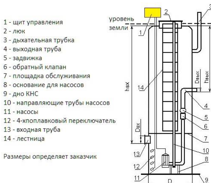
Рисунок 2.98 – Общая схема устройства «КНС» с погружными насосами
