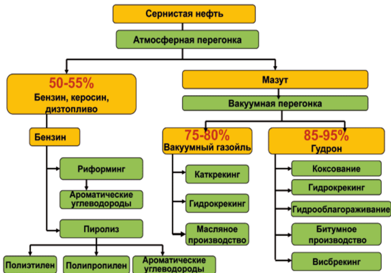
Рисунок 1.14 – Изменение глубины переработки нефти
