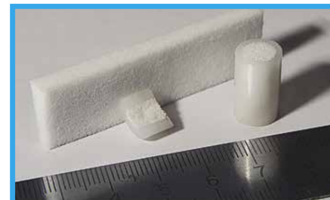
Первый слой полимерного имплантата сплошной, он имитирует кортикальную кость для обеспечения механической прочности. Внутренний слой имеет поры, поэтому может быть колонизирован клетками реципиента
