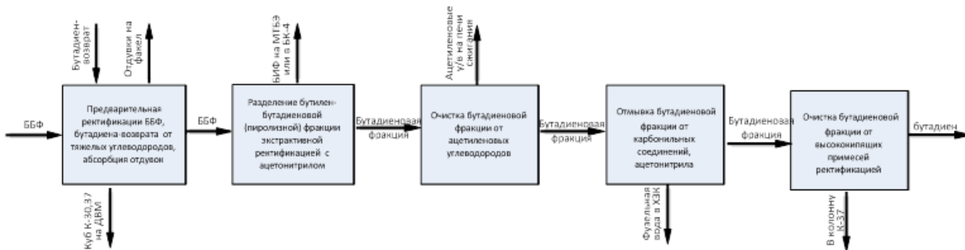
Рисунок 2.4.1 — Схема получения 1,3- дивинила методом экстрактивной ректификации с использованием ацетонитрила
