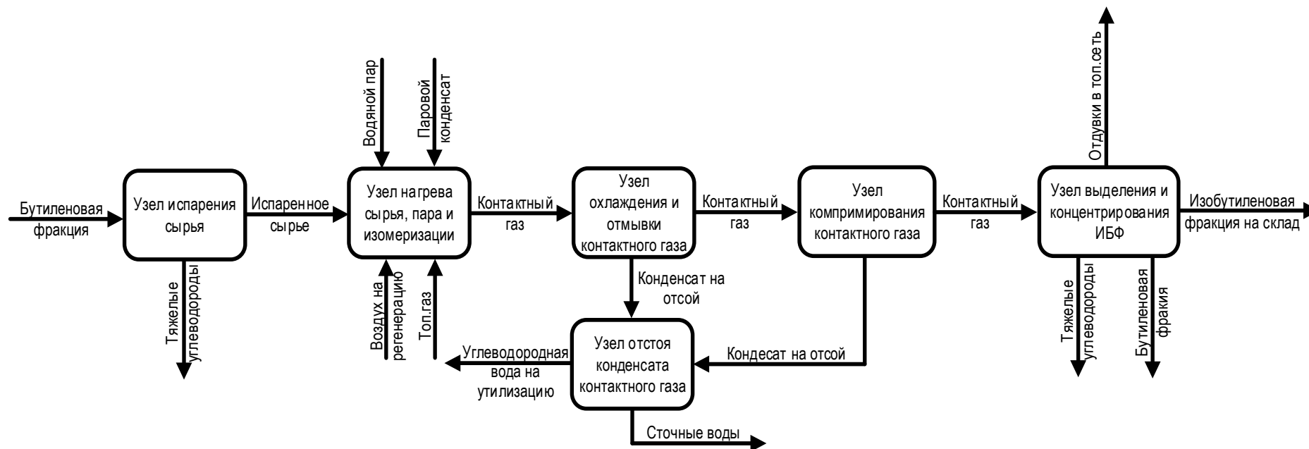
Рисунок 2.3.2 – Блок-схема процесса изомеризации нормальных бутенов в изобутилен
