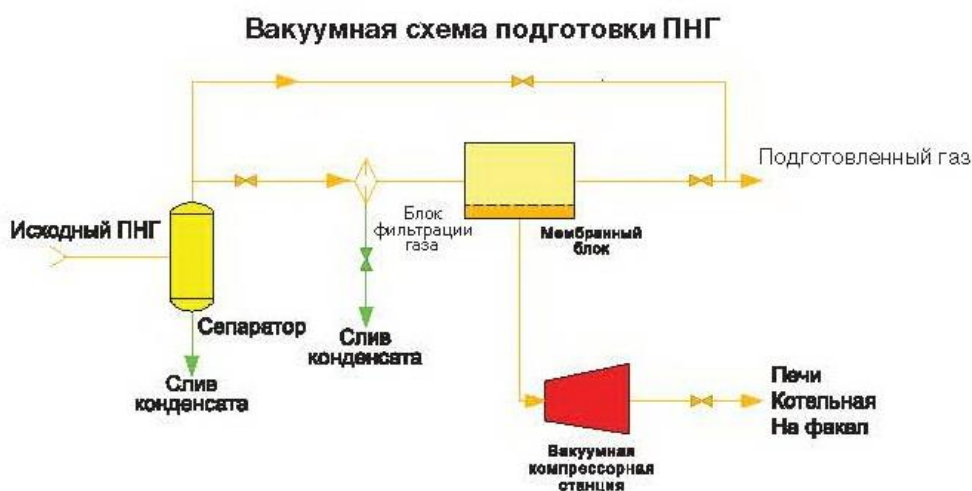
Рисунок 7.18 – Вакуумная схема мембранной подготовки ПНГ
