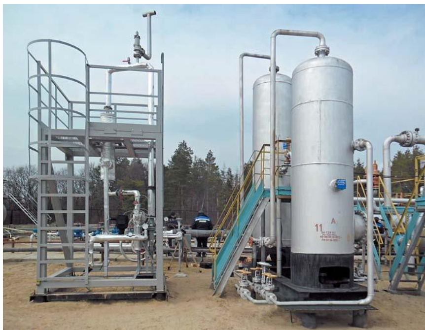
Рисунок 7.12 – Мембранная гелиевая установка
