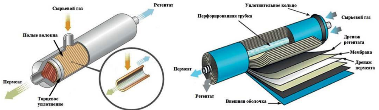
Рисунок 7.11 – Конструкция поволоконного (слева) и рулонного (справа) мембранного элемента
